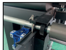
Barra inflexible que facilita el avance y retroceso de las bobinas.
