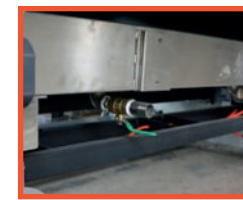
Tanque de agua integrado para la limpieza automática de la correa.
