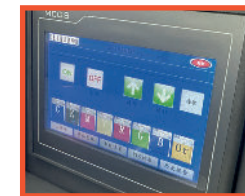
Pantalla LCD para supervisar la estabilidad del sistema y facilitar su ajuste.
