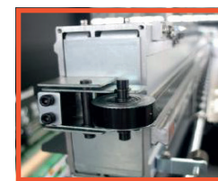
Sistema de poleas de tensado de alta precisión y gran estabilidad.
