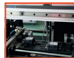
Sensor de rectificación de correa que mantiene la alineación correcta durante el funcionamiento.
