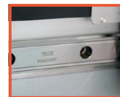
Guía lineal THK de alta precisión y funcionamiento silencioso.
