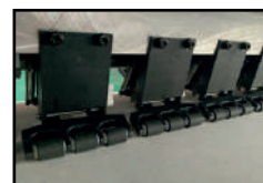
Rueda de presión, permite la correcta alimentación, uniformidad, estabilidad de los papeles de bajo gramajes.
