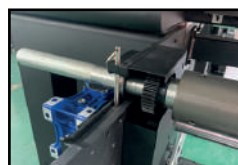
Barra inflable que facilita el avance y retroceso de las bobinas.
