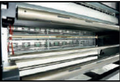
Guías de ranura vertical con absorción, para trabajar los papeles de bajo gramajes.
