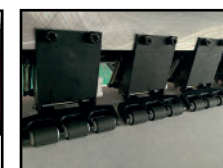
Barra de tensión de retracción del material.
