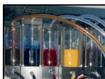
El sistema de suministro de tinta de presión negativa se utiliza para garantizar una impresión estable a largo plazo y precisa.
