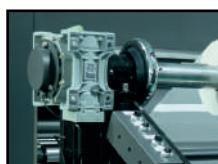
Sistema eficaz de desviación del paso y la variación de velocidad causadas por materiales de diferentes diámetros durante la alimentación.
