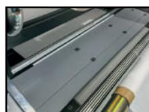
El calentador integrado en la parte inferior facilita la carga y la recogida, lo que mejora la eficiencia del calentamiento y es más adecuado para realizar muestras para el cliente.
